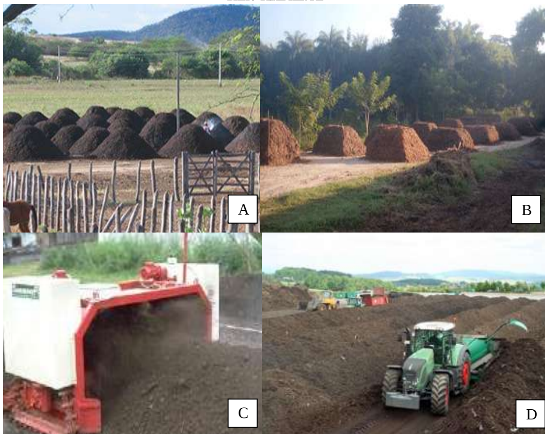
Foto 27 – Sistema de compostagem mecanizado (A e B – Pilhas de compostagem; C e D – Montagem de leiras mecanizadas) – imagem ilustrativa.
